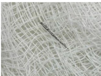
Figura 3 - Fragmento da lima removida do interior do canal.
